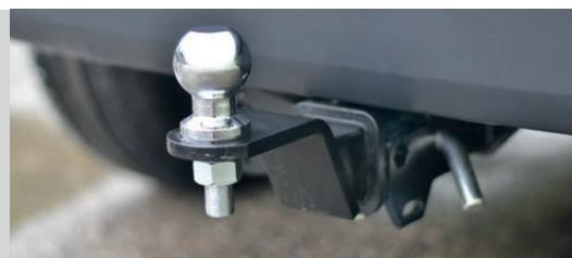
Тип соединения: шаровый; Диаметр сцепного шара: 50 мм.; Масса комплекта ТСУ 01301501: 13 кг.
